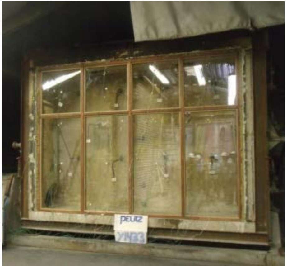
Figuur 2. De testopstelling voor verschillende typen beglazing in het laboratorium van Peutz.
