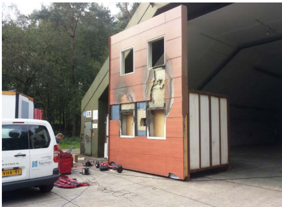
Figuur 4. Beeld van de meetopstelling (zeecontainer). De openingen in de gevel zijn dichtgezet.
