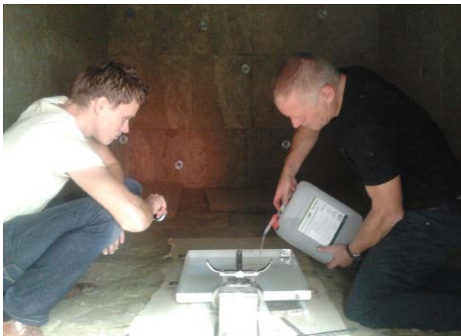
Figuur 5. Vullen van de ethanol-brandopstelling in de geïsoleerde zeecontainer.
